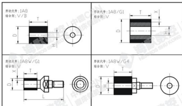
陶瓷结合、树脂结合剂、金属结合剂 CBN 砂轮；
